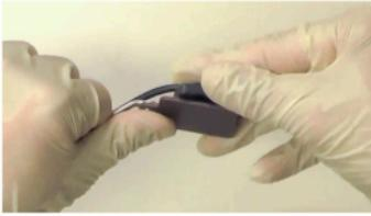
**1** CCDセンサーを固定プレートに合致します。
